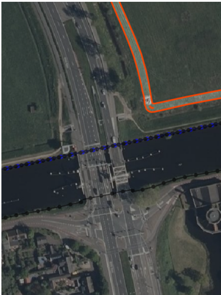
Afbeelding 4.6 Ligging ondergrondse hoogspanningsleiding (rood)
