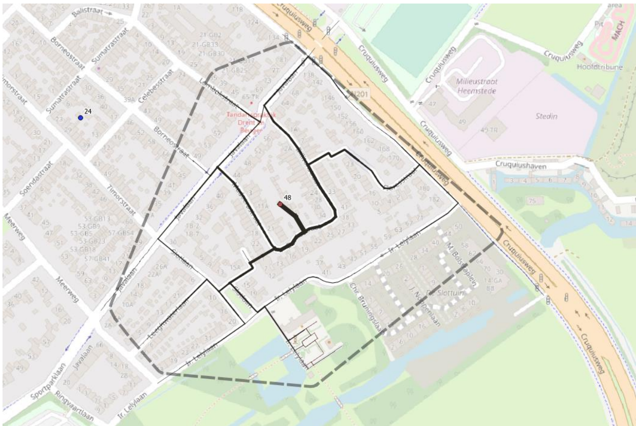
Figuur 10: Voorbeeld leidingen op straatniveau, 3 km leidingwerk van het distributienet van één verdeelstation
