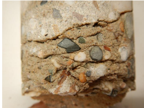
Afbeelding 3: Scheurvorming langs toeslagmateriaal
