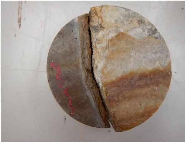
Afbeelding 2: Zichtzijde ASR1 met uitbloei.
