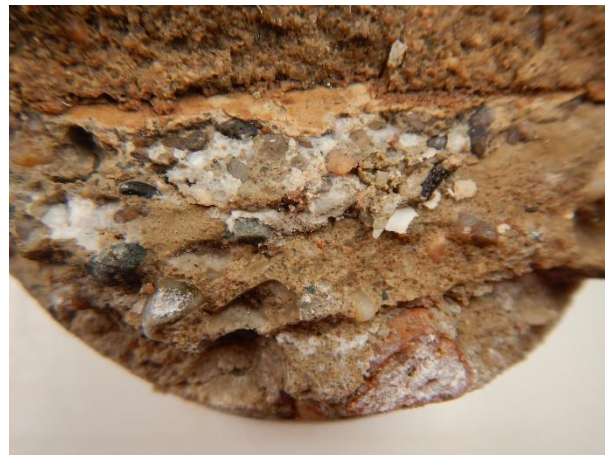
Afbeelding 5: Uitbloei breukvlak ASR2
