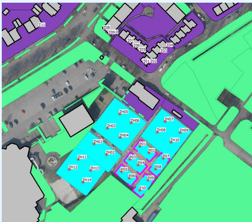
figuur 3: overzicht rekenmodel. De gekleurde vlakken geven het type bodemgebied (paars = licht absorberend, blauw = halfabsorberend en groen = absorberend). De rode lijnen zijn de glasplaten van de padelbanen.
