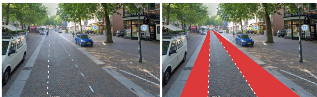
Figuur 25: Toepassing fietssuggestiestroken (links minimaal, rechts ingrijpend)
