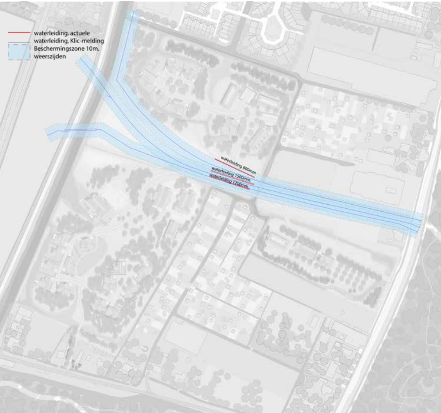
Buisleidingenbeschermszone voor waterleidingen PWN en Waternet
