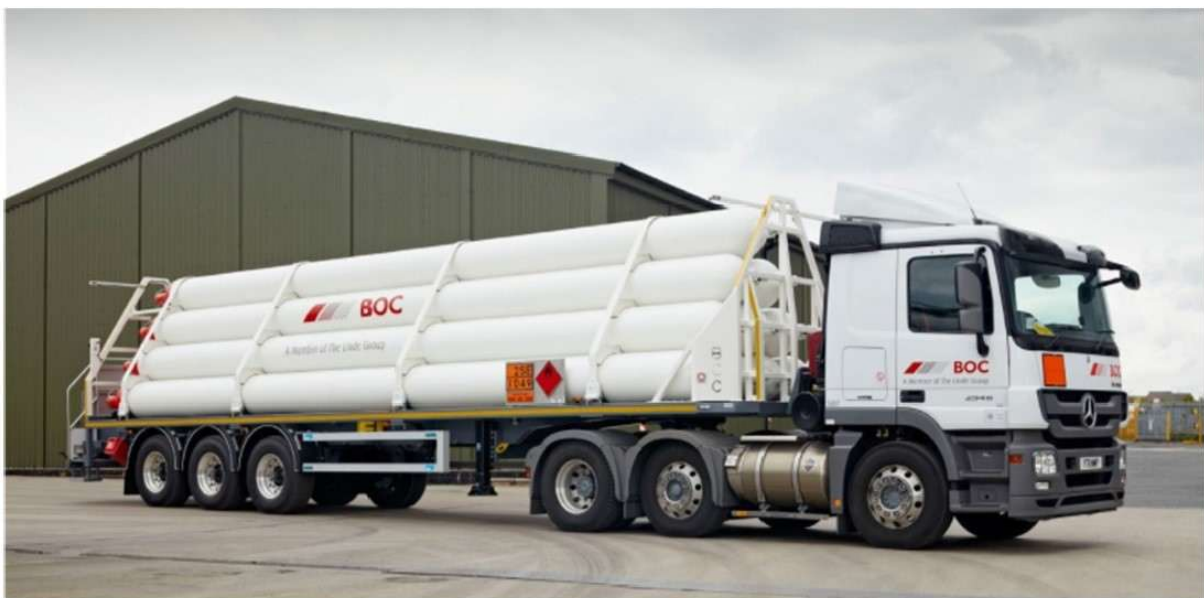
Een tube-trailer met 9 stalen drukcilinders (200 bar) (M-Tech, 2020)
